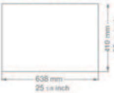
Ausschnittmaß Draufsicht Cut-out dimension, top view Côte de coupe, vue de dessus
